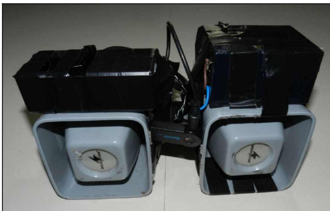
Foto 22: Sistema di emissione: amplificatore, due casse, batteria e Bluetooth per collegarlo al cellulare.
