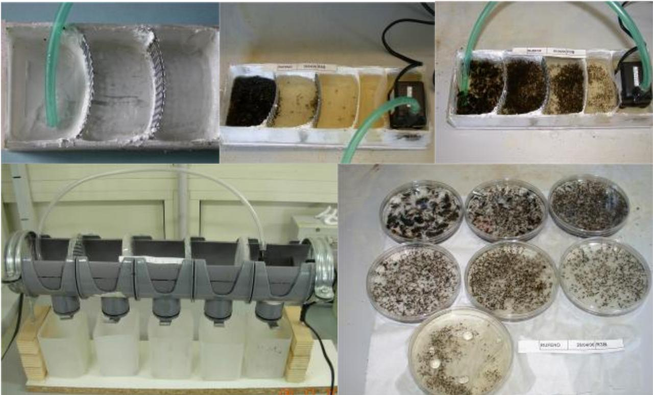
**Fig. n°15. – Strumenti progettati e realizzati per separare gli insetti raccolti, in base alle dimensioni.**
