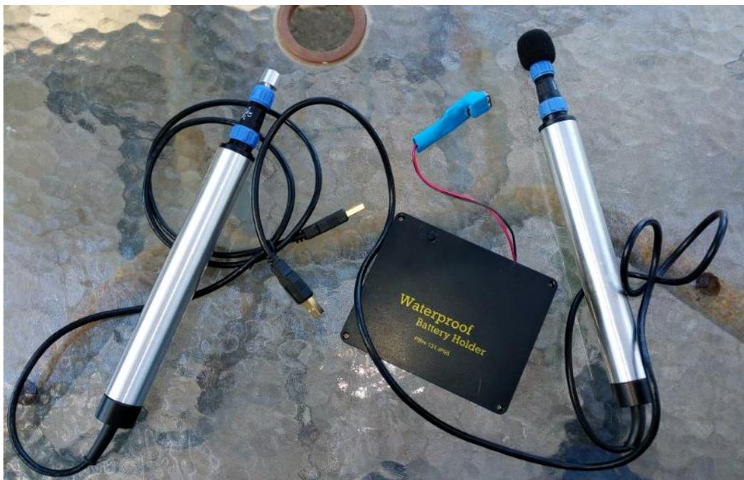
**Figura 6.** I microfoni ultrasonici della Ditta Dodotronic, con campionamento a frequenza di 384 KHz, in uso per il monitoraggio 2018 della Chiroterrofauna del Parco.
