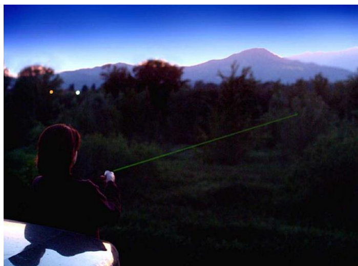
Figura 22: Pistola a luce laser per l'allontanamento degli uccelli ai posatoi. Immagini tratte da http://www.thisnext.com/tag/laser-gun .
