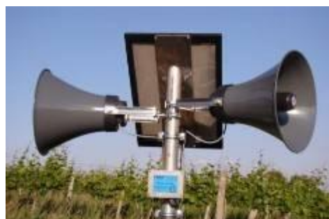
Figura 16: Esempi di dispositivi per la dissuasione acustica; riproduzione a largo raggio di richiami di allarme specie-specifici. Fonti: http://icwdm.org/handbook/birds/Dispersal.asp e http://www.birdcontrol.at/raptor_r56solar.html .
