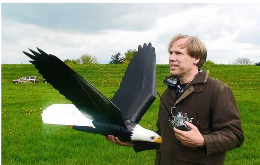
Figura 21: Rapace-robot radiocomandato per l'allontanamento di uccelli dagli aeroporti.
