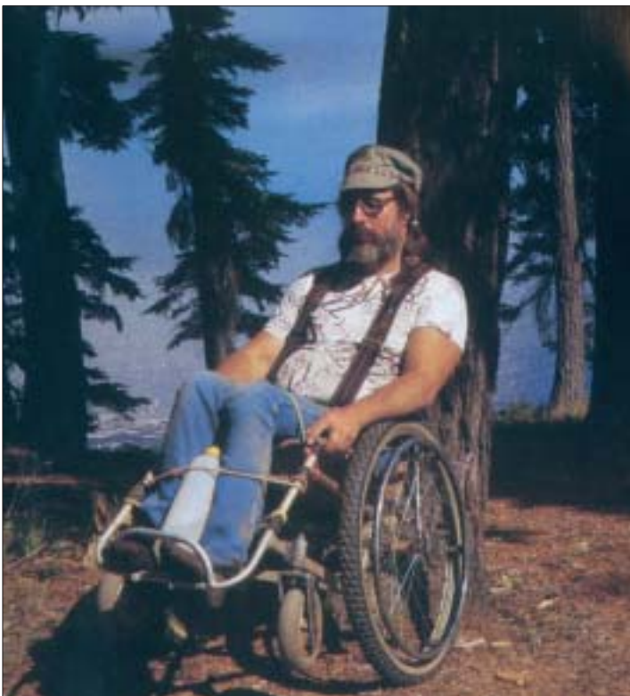
Foto n. 68 - Carrozzina manuale con ruote da mountain bike, adatta a fondi sconnessi o non compattati.
