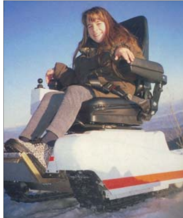
Foto n. 67 - Carrozzina elettronica con trazione costituita da cingolati, adatta a fondi ghiacciati, anche con forti pendenze; adatto anche ad un servizio noleggio.
