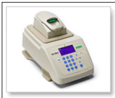
Figura 7 - il termocicizzatore BIORAD con il quale sono state condotte le amplificazioni PCR nel presente lavoro
