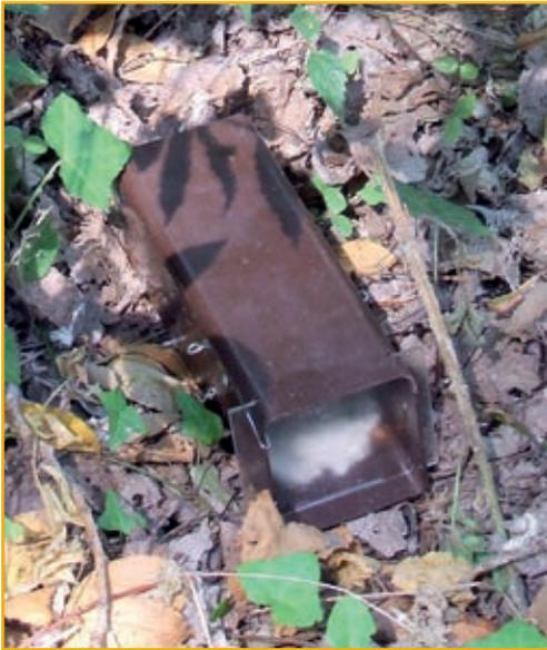
**figura 19** Trappola tipo L.O.T.: è visibile la “finestra” rimovibile per liberare l’animale, l’altra estremità ospita il “cannelletto” metallico collegato al meccanismo di scatto interno - FOTO DI F. PICCARI
