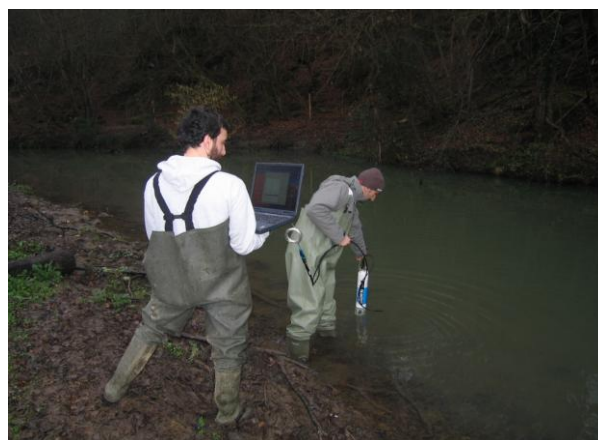
Figura 2.11: Prelievo dei parametri chimico-fisici tramite una sonda multiparametrica.
