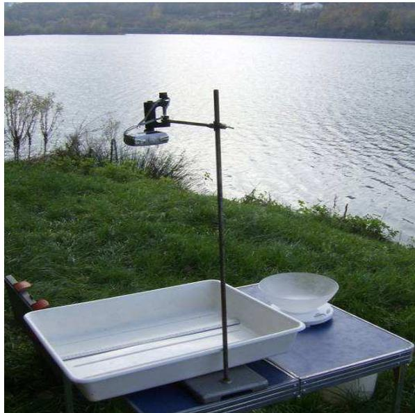
Figura 2.10 - stativo utilizzato per la misurazione dei pesci
