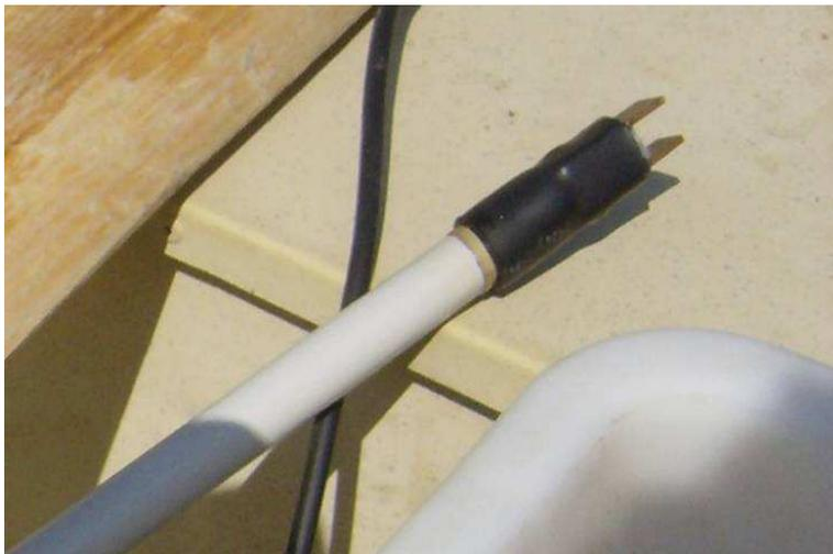
Figura 2.11 - Sonda utilizzata per misurare il campo elettrico.
