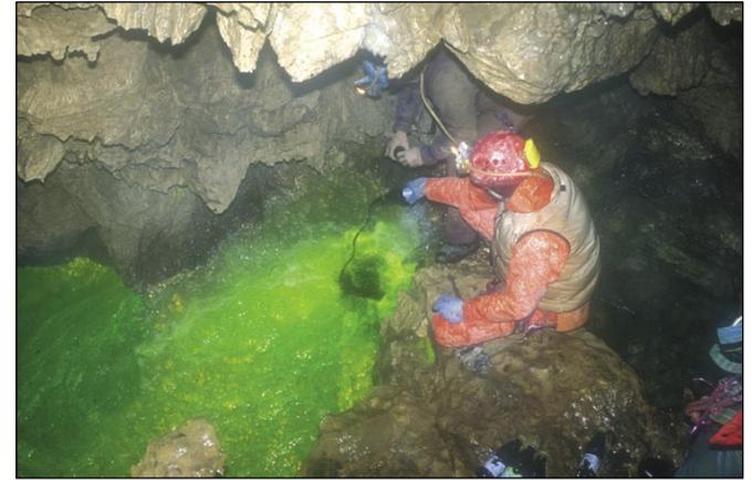
**Abisso di Monte Vermicano:** la colorazione del torrente interno con fluorescina il 12 aprile 2003; le acque sono tornate alla luce 12 ore dopo alla sorgente Caporelle (foto A. Zambardino)
